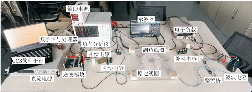
图 15 LCC-S 型 WPT 系统实验平台
